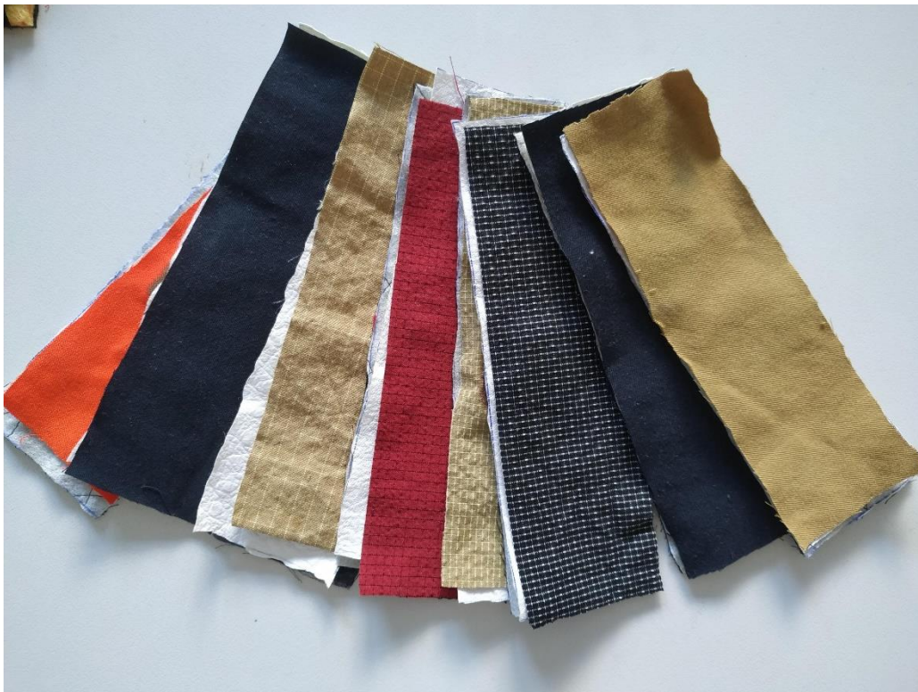
Abbildung 4: Probenauswahl zur Oberstoffvariation, Zuschnitt für den Strahlungsprüfstand
