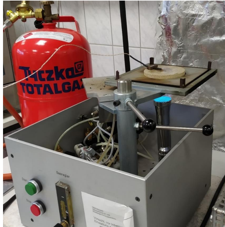
Abbildung 9: Versuchsaufbau Flammeneinwirkung auf Feuerwehrsutzhleidung: Kleidung liegt unter dem runden Kalorimeter und wird beflammt.
