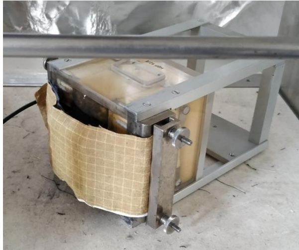
Abbildung 6: Kalorimeterblock aus Aluminium (Normung [DIN EN 366]) mit Probenhalter (und eingespannter Kleidung)
