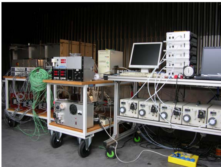
Abb. 46: Ansicht der Messtechnik mit den Gasanalysesystemen
