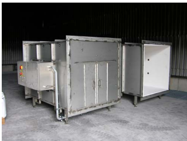
Abb. 39: Brandraum und Flur der Versuchseinrichtung
