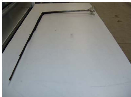
Abb. 44: Skizze und Bild der Gassonde für Messungen über den Raumquerschnitt
