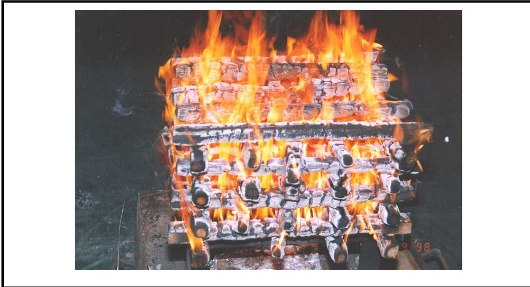
**Abbildung 2.9:** Holzkrippenbrand mit Wärmeübertragung durch Konvektion und verschiedenen Lagen der Brandstoffoberflächen
