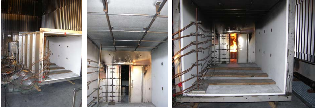
Abb. 2: Versuchseinrichtung mit Brandraum und Flur
