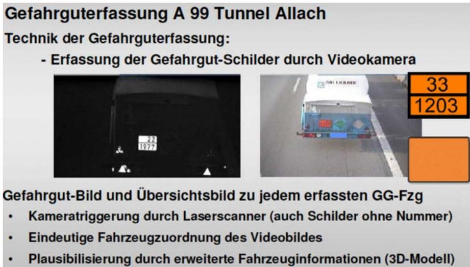
**Abbildung 2.7:** Scannen des UN-Codes bei der automatischen Gefahrguterfassung [FELDGES 2010]
