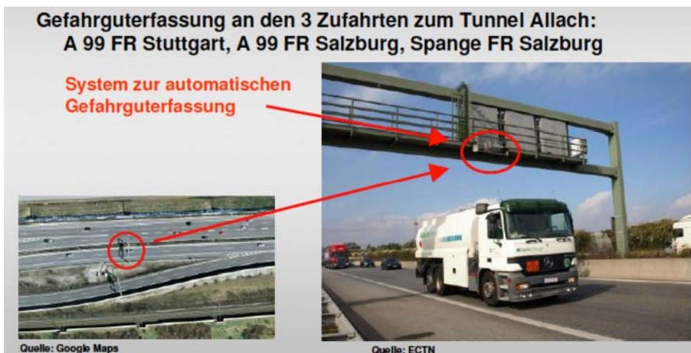
**Abbildung 2.6:** Automatische Gefahrguterfassung mit Hilfe der Laser-Scanner-Technologie [FELDGES 2010]
