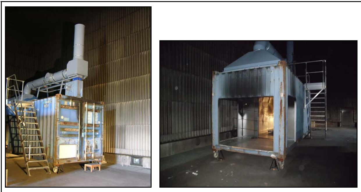
Abbildung 2.9: Aufbau der Versuchsanlage im Brandraum 2 des Brandhauses am IdF LSA mit Blick auf die Containertür (links) und Blick auf Abgasraum und Esse (rechts)
