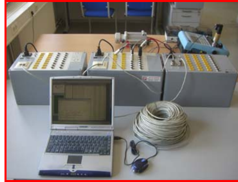
Bild B2: Drei Messboxen mit Erfassungsrechner
