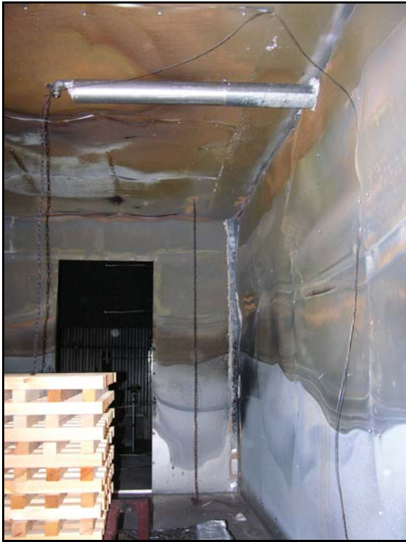
Abbildung 2.26: Versuchsanordnung in der Brandkammer für Versuch 4 (Holzkrippenbrand 8A und Vollkegeldüse 460.924)
