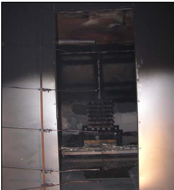
Abbildung 2.31: Holzkrippe nach 10min Löschwasserbeaufschlagung mit 20l/min (Löschversuch 8A_120917)
