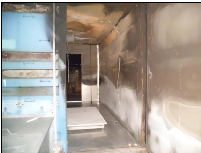
Abbildung 2.10: Brandkammer mit Abbrandwaage
