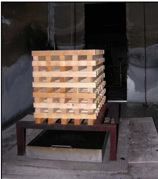
Abbildung 2.14: Normholzstapel 8A mit Zündwanne nach DIN EN 3-7
