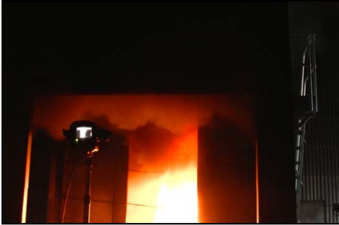
Abbildung 2.25: Blick auf die Seitenöffnung im Abgasraum während des Holzkrippenbrandversuches
