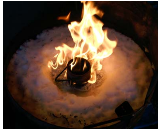
Abbildung 24 : Rückbrand durch Schaumschicht Abbildung 25 : Beginnender Rückbrand durch zerstörte Schaumschicht
