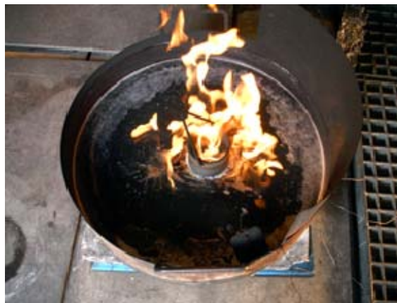
Abbildung 26 : Rückbrand nach zerstörter Schaumschicht beim NMP
