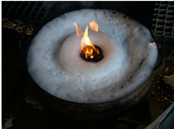
Abbildung 22 : Zylinderbildung des Schaums um Rückbrandgefäß
