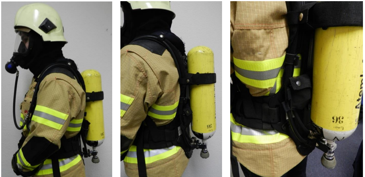
Bild 5.5: Gesamtansicht der Anbringung der Messtechnik am Pressluftatmer
