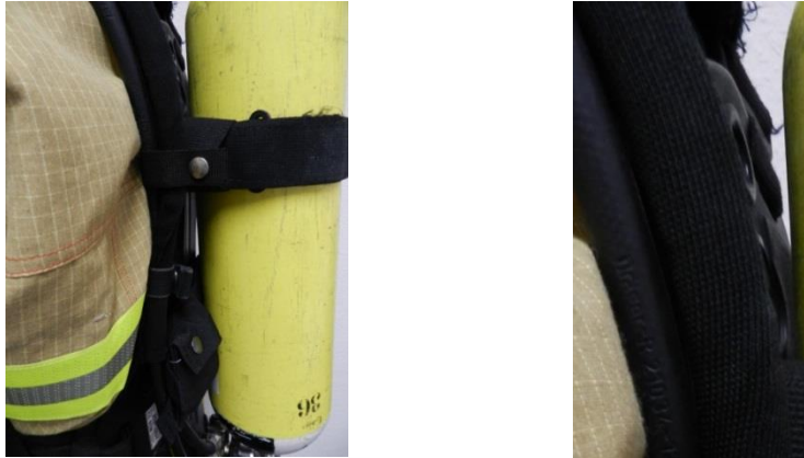
Bild 5.3: Textiler Kabelschuttschlauch HELAHOOK15 zur Fixierung der Ausgleichsleitung an den Leitungen des Pressluftatmers; links: Seitenansicht mit verlegter Ausgleichsleitung und Kabelschuttschlauch; rechts: Detailansicht des Kabelschuttschlauches
