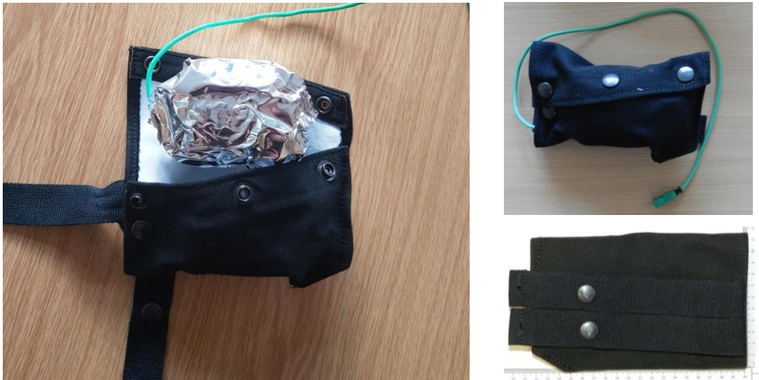
Bild 5.2: Tasche des Safety Belts der Firma Dräger in verschiedenen Ansichten (links: Frontansicht mit eingelegtem und thermisch isoliertem Datenlogger; rechts oben: Frontansicht mit eingelegtem Datenlogger mit geschlossener Tasche; rechts unten: Rückansicht)
